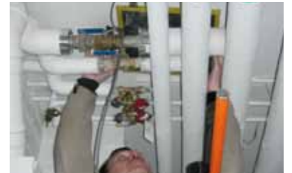
Digitaalinen röntgenkuvaustapahtuma (käyttövesiputkisto).
